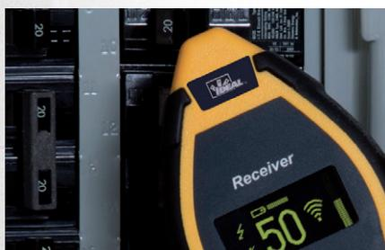
Im Sicherungs-Modus erkennt der Empfänger den Stromkreis, an den der Sender angeschlossen ist.
